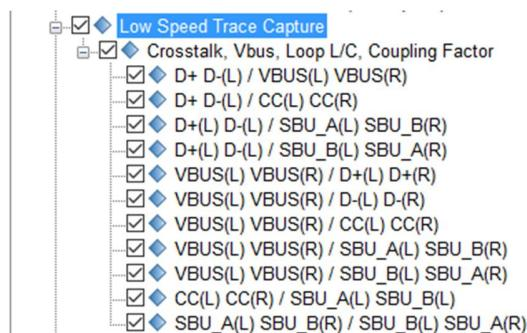
FIGURE 28. SELECT LOW SPEED TEST PARAMETERS FOR TRACE CAPTURE
