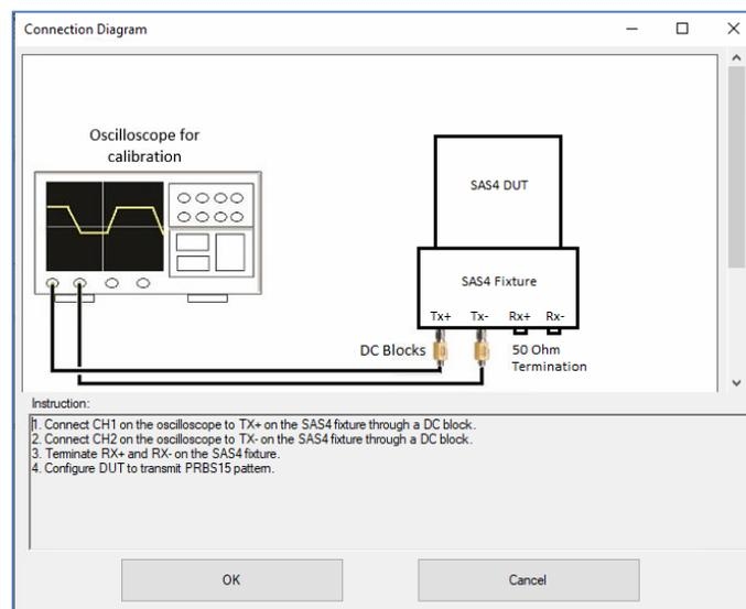
FIGURE 13. CONNECTION DIAGRAM POP-UP WINDOW EXAMPLE
