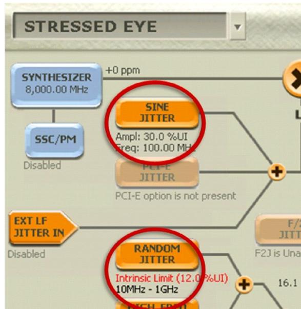
FIGURE 49. STRESS LEVEL CONFIGURATION
