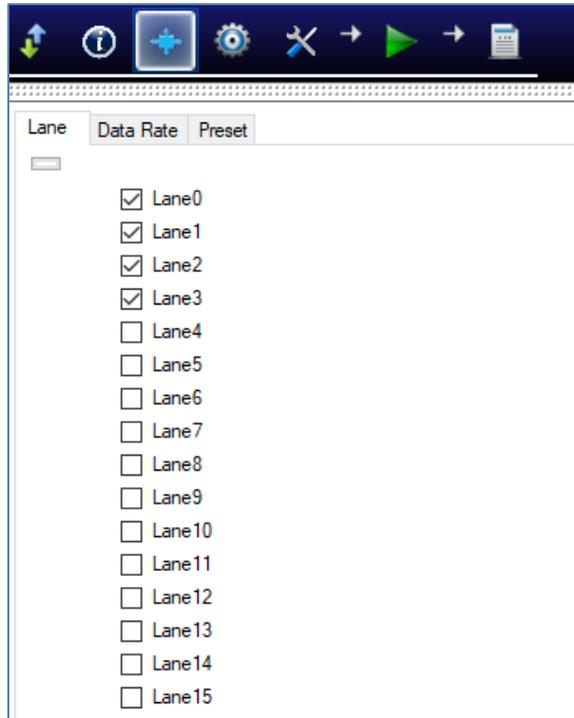
FIGURE 7. SELECT LANE UNDER TEST
